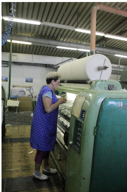
Obr. č. 3 Nylonové nitě na prošití textilie se zakládají ručně
