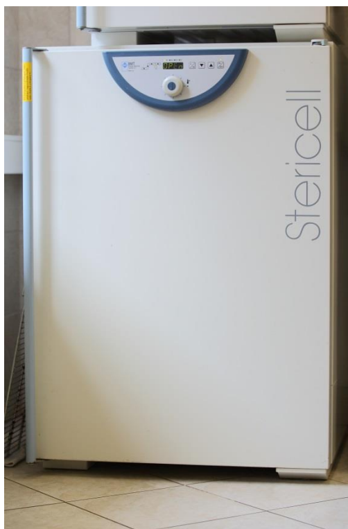
Obr. č. 9 Horkovzdušný sterilizátor
