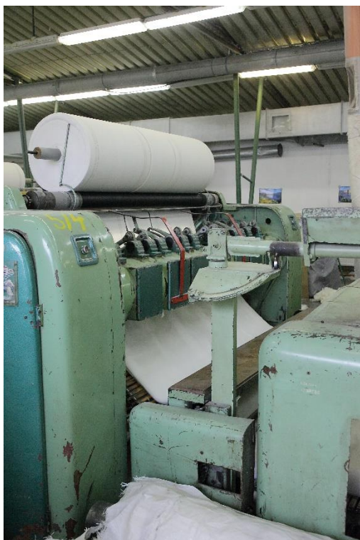
Obr. č. 2 Zpracovaná a prošívaná textilie se strojově stříhá na pásy různých rozměrů
