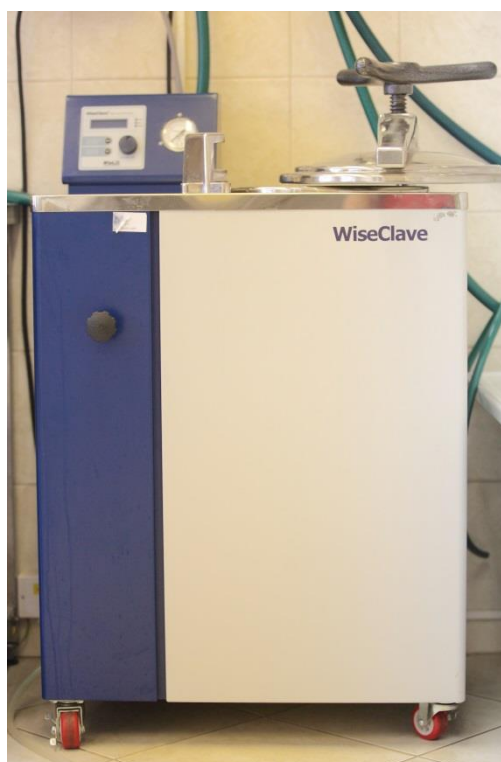
Obr. č. 8 Parní sterilizátor
